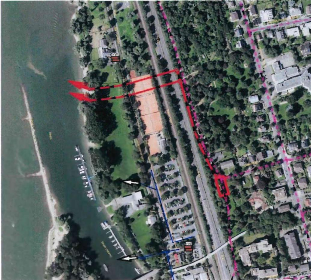
Abb. 1: Luftbildausschnitt des Plangebietes mit Verlauf der Kanalleitungen, Auszug aus dem Übersichtslageplan zur Entwurfsplanung (ohne Maßstab)
